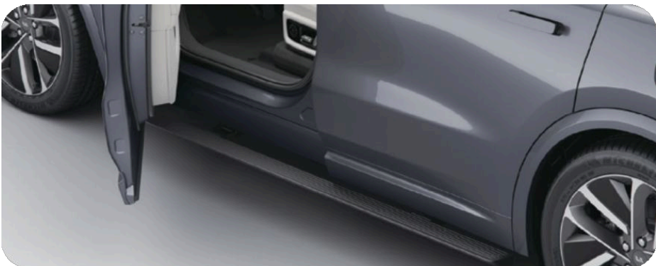
Выдвижные пороги с электроприводом
